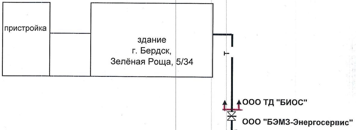
Граница раздела зон ответственности проходит по выходному фланцу задвижки на подающем трубопроводе и по входному фланцу задвижки на обратном трубопроводе.
